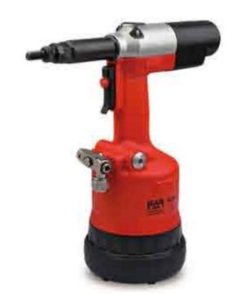
Valigetta di plastica contenente una rivettatrice oleopneumatica per inserti filettati con tiranti e testine M4 ÷ M12.
