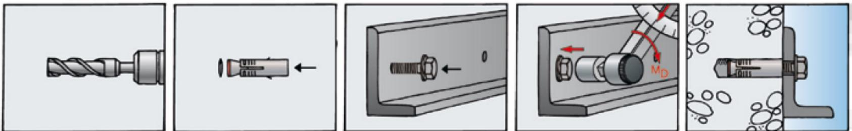
Si raccomanda un'accurata pulizia del foro prima dell'installazione.
