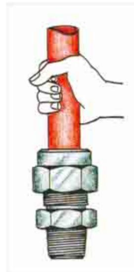
Verificare la completa adesione del tubo al corpo, forzando il medesimo verso l'interno del raccordo e quindi, con la chiave, bloccare il tubo.
