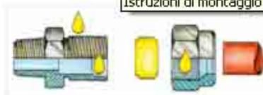
Oilare le filettature del dado e del corpo del raccordo, compresa l'ogiva. Quindi infilare sul tubo dado e ogiva, facendo attenzione che quest'ultima abbia la parte tagliente verso il raccordo.
