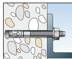
Si raccomanda un'accurata pulizia del foro prima dell'installazione.
