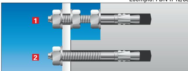
**1** Lunghezza utile dell'ancorante aumentabile fino ad un massimo di 40 mm (profondità minima di ancoraggio => carico ammissibile ridotto).
