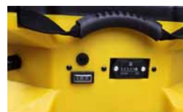
CDX 20 pannello di controllo, conta ore
